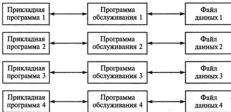
Рис. 4.1. Взаимно-однозначное соответствие между прикладными программами и файлами данных
